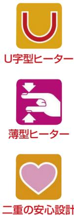
●速熱・即暖に優れたハロゲンランプをU字形にして発光長を長くしたことにより放射面積を上げ、スイッチオンで光がバツと灯り、対流ファンで温風が広がり、コタツ内部をムラ無く暖めます。ストレート形ヒーターの発光長50mmに対し、U字形ヒーターの発光長は385mmです。発光長が長くなる分、表面温度が低くなりますので、座椅子が焦げる等の事故も低減出来ます。
